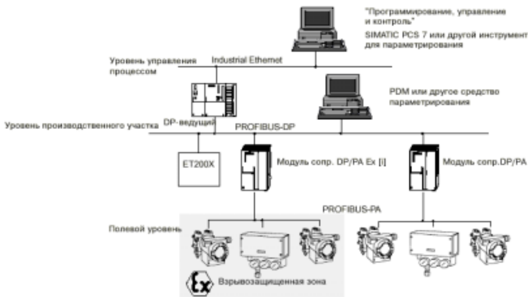
Рисунок 2-15 Подключение модуля сопряжения DP/PA в систему
